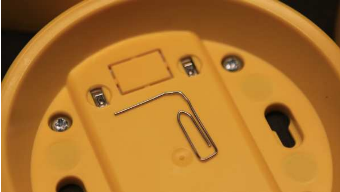
Figur 1: Ladefjedrene i en Slappuk ladestation plus en papirclips!
