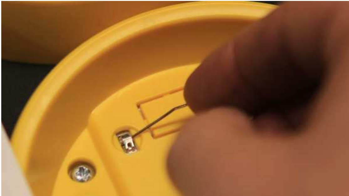
Figur 3: Tilbagebøjning af en ladefjeder med en udfoldet papirclips
